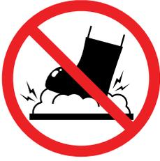
使用中、雪を多く入れすぎたり、雪を踏み潰して排気を塞ぐと不完全燃焼となり煙を発生する他、排気ガスによる中毒の恐れがあります。
