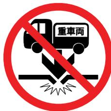
融雪機の上に普通乗用車以上の重車両物が載るとフタや本体が破損する他、車両等にも損害を与える恐れがあります。2.0 t以上の重車両は載せないで下さい。
